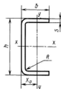
$h$  — высота стенки;  $b$  — ширина полки;  $s$  — толщина швеллера;  $R$  — радиус кривизны;  $W$  — момент сопротивления;  $I$  — момент инерции;  $i$  — радиус инерции;  $S_x$  — статический момент полусечения;  $x_0$  — расстояние от оси  $y - y$  до наружной поверхности стенки;  $\eta = \frac{b - (R + s)}{s}$  — отношение расчетного свеса полки к толщине швеллера;  $\eta_1 = \frac{h - 2(R + s)}{s}$  — отношение расчетной высоты к толщине швеллера
